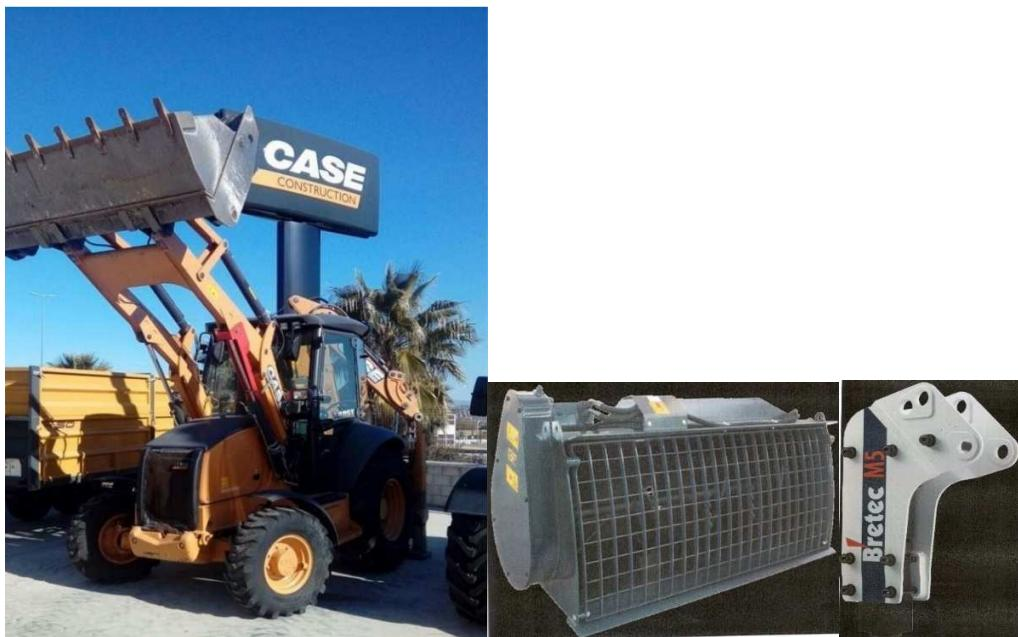
**Slika 2. Kombinovana mašina – rovokopač sa dodatnom opremom (kašika - mješalica za beton, hidraulični čekić)**
